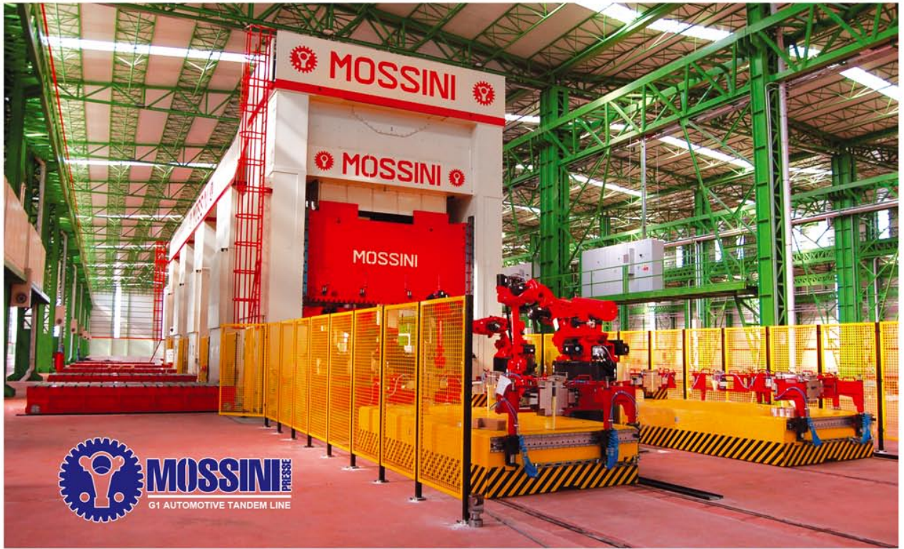
N.1 PDM-4B-LD-2000 (TABLE SIZE 5000x2500 mm.) + N.4 PDM-4B-1000 (TABLE SIZE 5000x2500 mm.)
