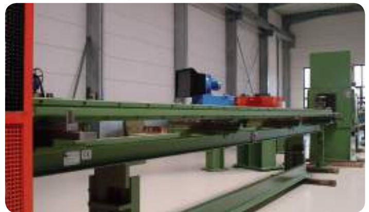
⑩ Rohrführung Tube Guide
