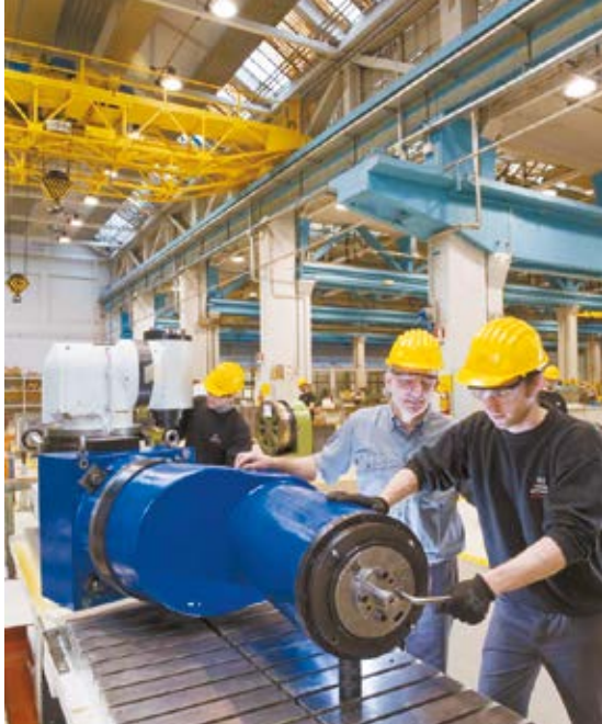
Fase di montaggio di una testa accessorio Assembly phase of an attachment head
