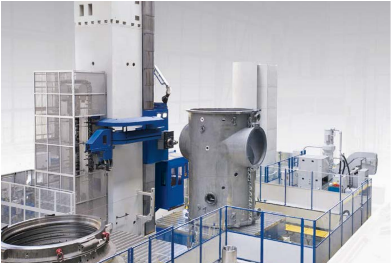
▲ ENERGIA / ENERGY Lavorazione componenti casse turbine gas Gas turbine casing component machining
