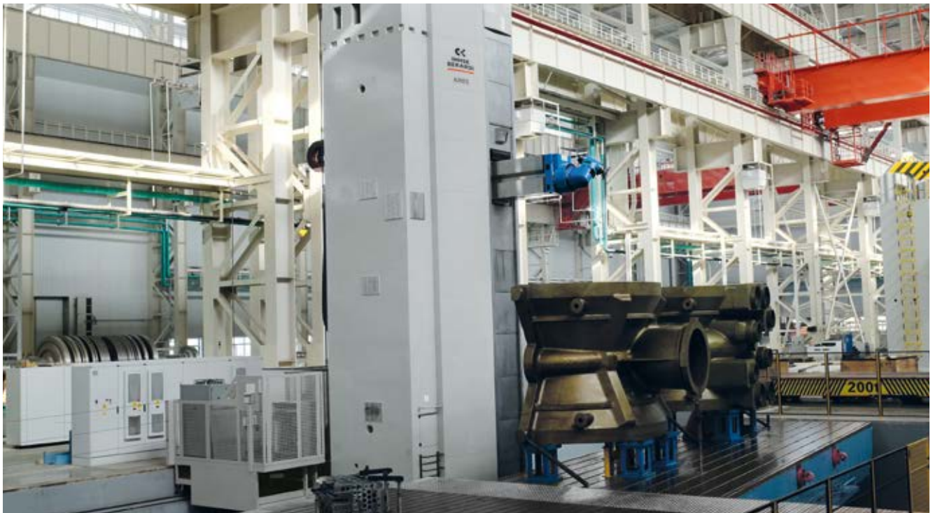
ENERGIA / ENERGY Lavorazione componenti cassa turbina Turbine casing machining
