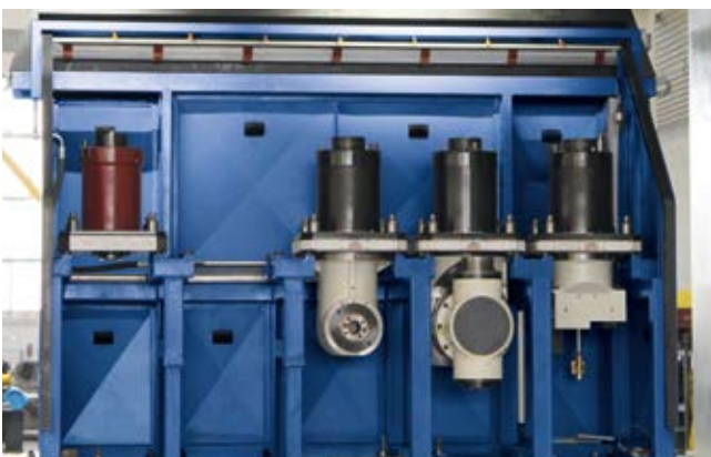
◀ SISTEMA PER CAMBIO AUTOMATICO DI TESTE ACCESSORIE AUTOMATIC ATTACHMENT HEAD CHANGER
