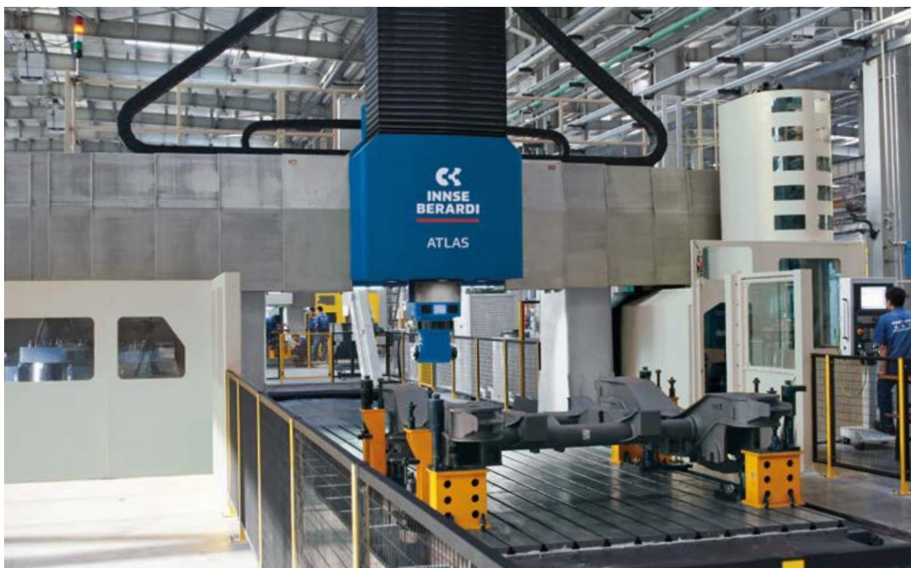
▲ FERROVIARIO / RAIL Lavorazione carrello Bogie machining
