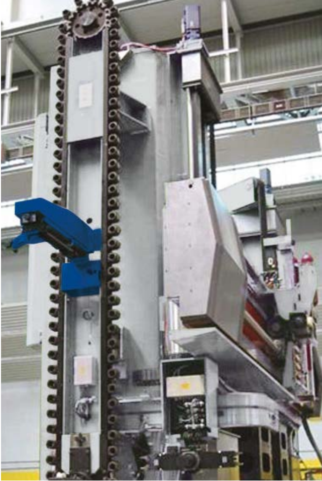
▲ MAGAZZINO UTENSILE A CATENA CHAIN TYPE TOOL MAGAZINE
