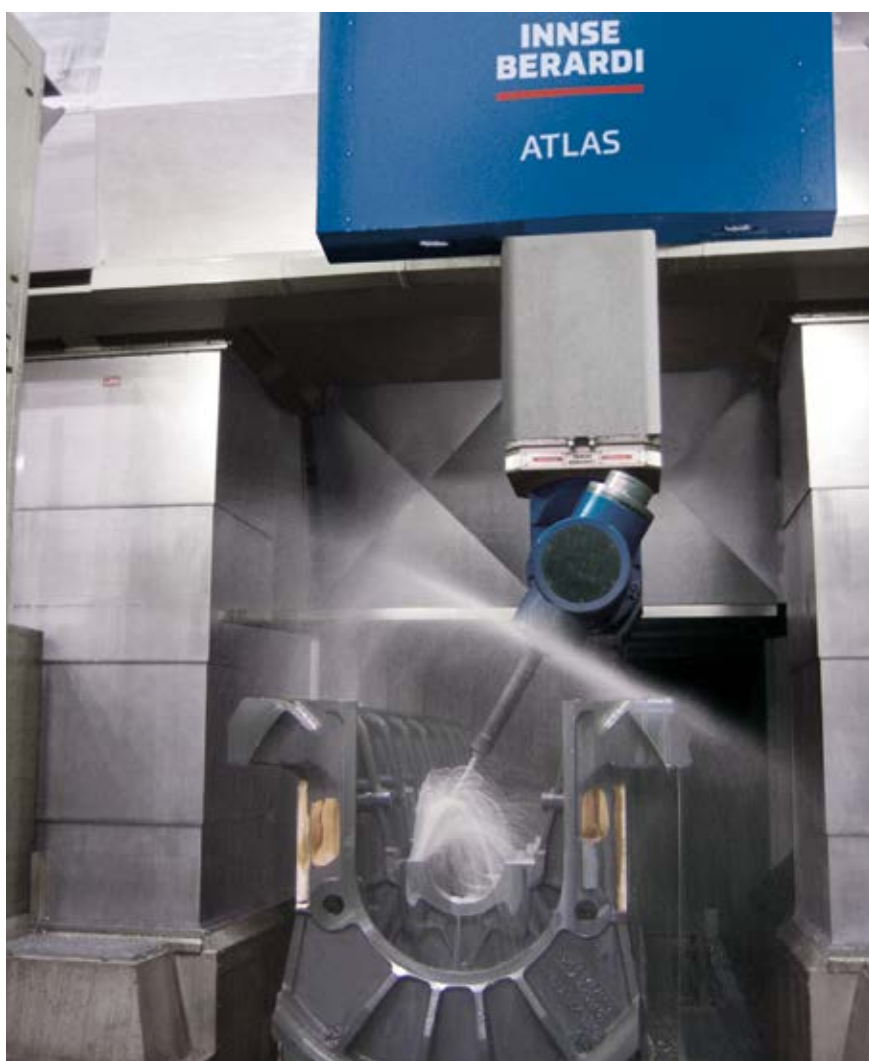
◀ FERROVIARIO / RAIL Lavorazione blocco motore Engine block machining
