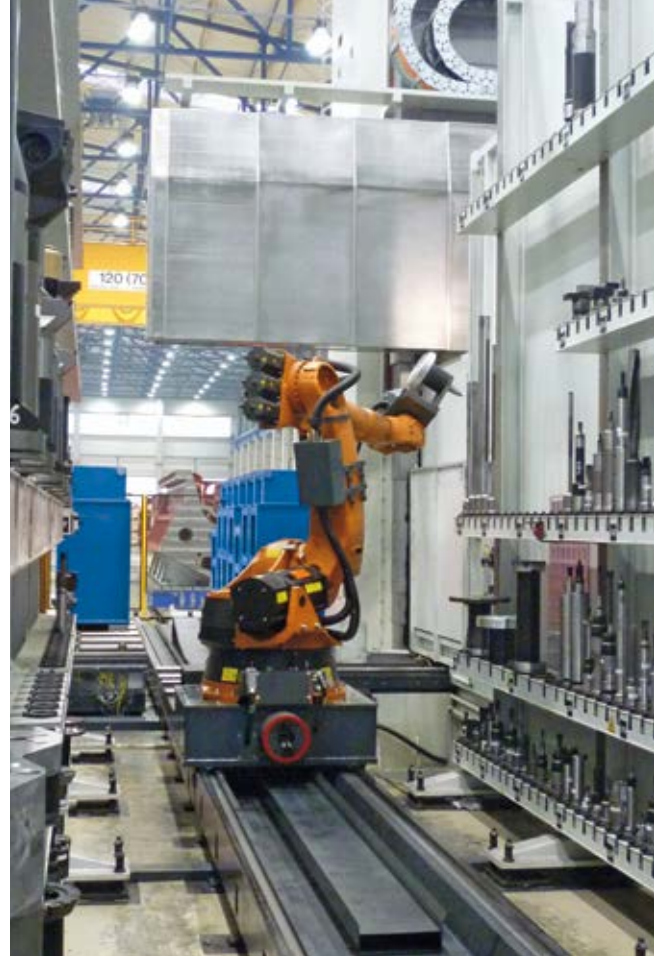
▲ MAGAZZINO UTENSILI ROBOTIZZATO ROBOTISED TOOL MAGAZINE
